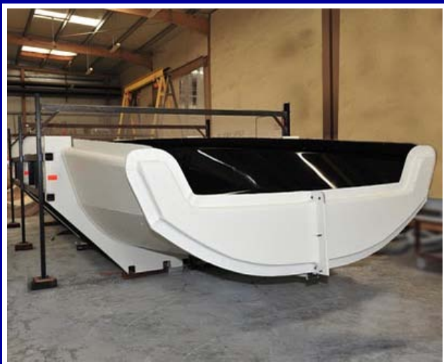
LA MAQUINA QUE MOLDEA EL POLIURETANO EXPANDIDO, PARA DAR FORMA AL MOLDE DEL CASCO.
