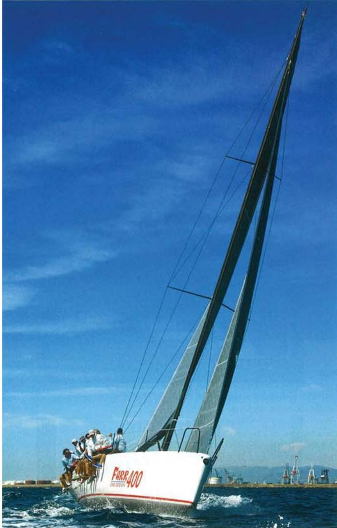
**Leichter geht es kaum: Der Kohlefasermast von Southern Spars ist mit Wanten und Stagen aus Carbon vom selben Hersteller geriggt**
